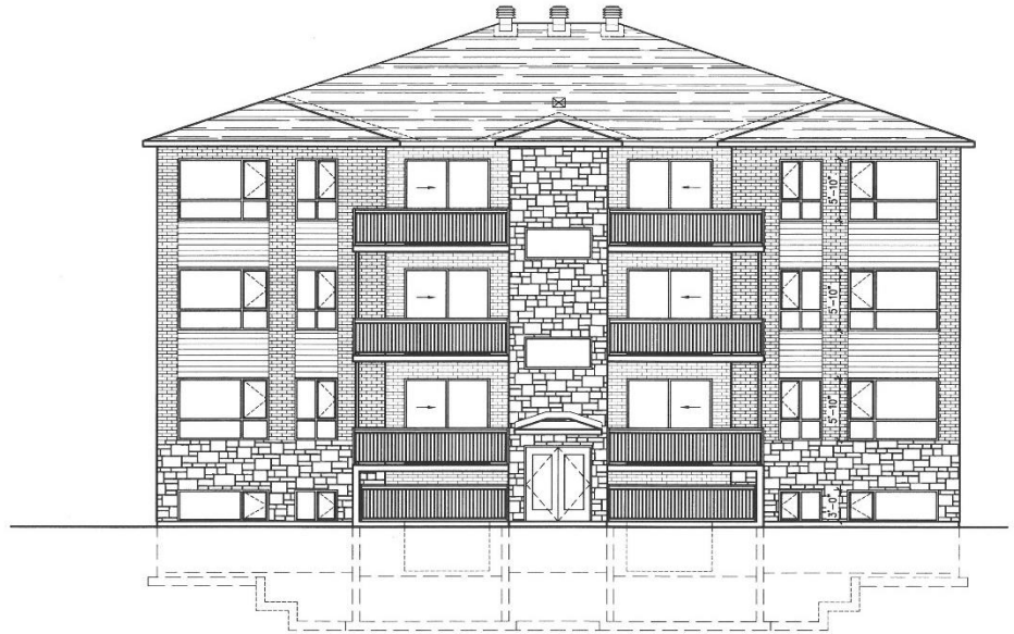
ÉLÉVATION AVANT ÉCHELLE: 1/8" = 1'-0"
